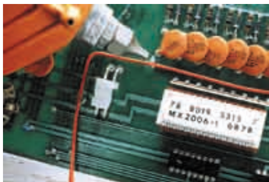
Маркировка печатных плат и устройств, подвергающихся воздействию высоких температур.
